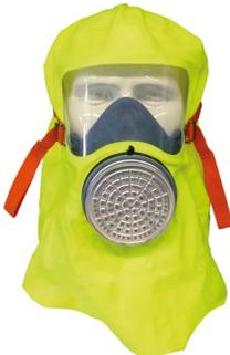
Die Gebrauchsdauer der Fluchthauben liegt bei ca. 15 Minuten. Sie schützen nicht bei Sauerstoffmangel und bei höheren Konzentrationen von Atemgiften (Aufnahmekapazität). Nach dem Gebrauch sind sie zu entsorgen.
