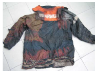
Die Einsatzschutzjacke – Spuren massiver Hitzeeinwirkung
